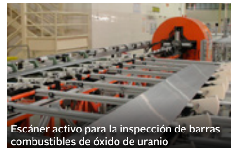
Sistemas robotizados para inspección de fugas de barras combustibles
